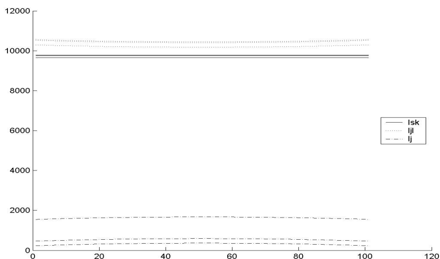
Figur 7, Returströmmens fördelning då jordtagsresistansen antas vara 2, 7 och 14 \Omega i var och en av skärmens ändar. Då jordtagsresistansen ökar, ökar den andel av strömmen som returneras i jord. X-axeln visar längdskala där 100 är hela kabelns längd (1000 m). Y-axeln visar strömmens absolutbelopp med spänningskälla 10 kV.
