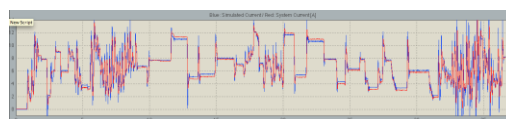
Figur 5. Jämförelse ström. Testdata (röd) och simulerade resultat (blå). Horisontal axel representerar tid[s] och vertikal ström [A]
